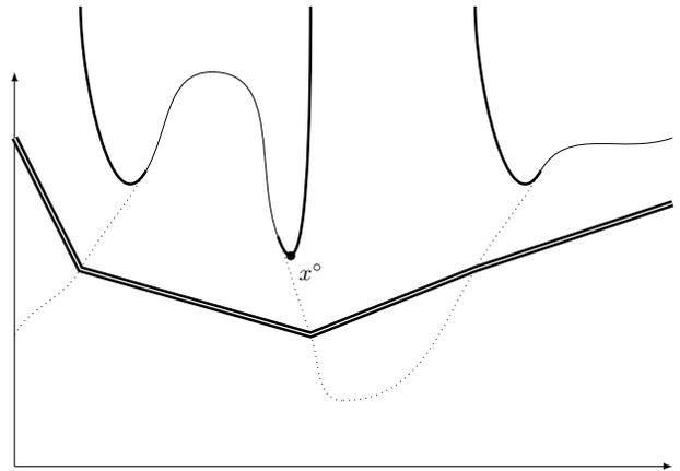
Si on diminue  $\mu$  alors la barrière s'affaisse et la solution optimale se rapproche de  $x^*$ .
