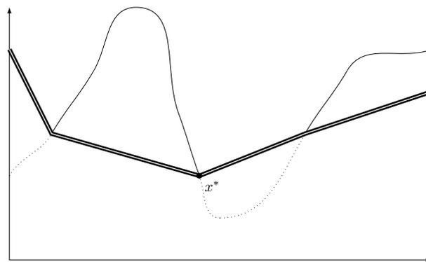
On applique une pénalité. On obtient une nouvelle fonction qu'on peut optimiser sans contrainte. On obtient la solution optimale  $x^\circ$  ci-dessous. On remarque que cette solution n'est pas dans  $S$ . C'est normal, dans le problème sans contrainte, on peut renvoyer une solution hors de  $S$ . L'objectif de la pénalité est d'être suffisamment élevée pour l'éviter.
